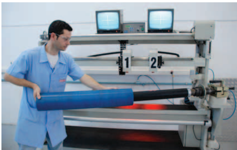
Preparação da montadora para montagem do clichê
