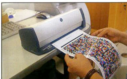
Impressora de oito cores e RIP sendo calibrados com espectrofotômetro motorizado
